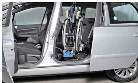
Porte coulissante avec ascenseur pour fauteuil roulant.
