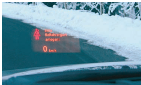
Rester concentré sur la route tout en étant informé sur la vitesse du véhicule grâce à l'affichage tête haute.
